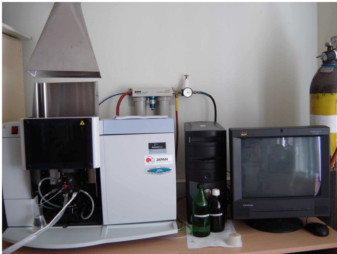
Atom Abszorpciós Spektrométer A Japán kormány ajándéka, 10 lámpával
