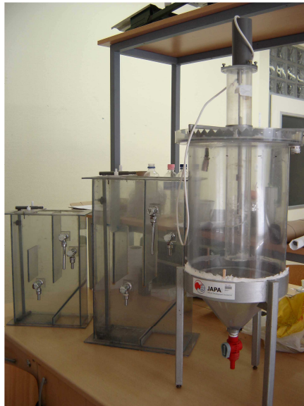
Kísérleti szennyvízkezelő rendszer Elsősorban biológiai szennyvízkezelési folyamatok vizsgálatára
