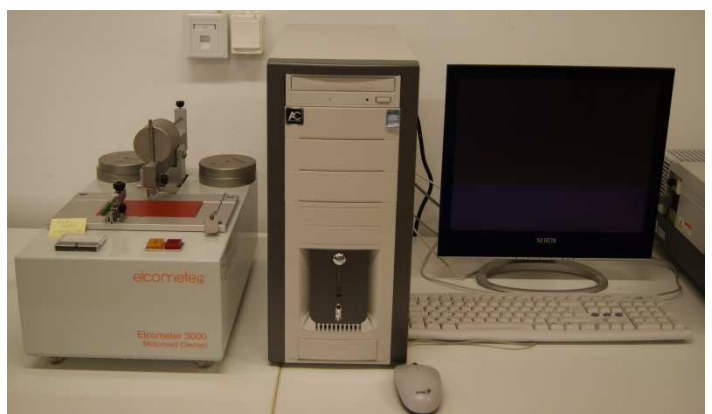
10. ábra Karcállóság vizsgáló készülék
