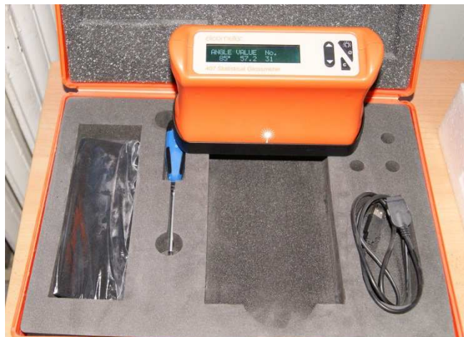
9. ábra Elcometer 407 fényességmérő készülék
