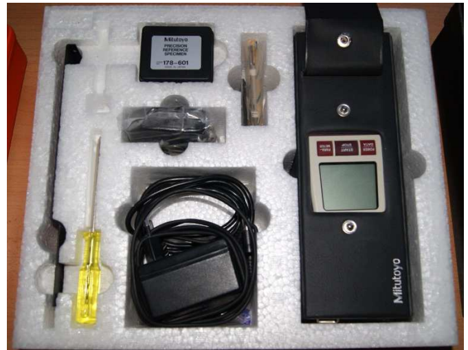
15. ábra Felületi érdességmérő készülék
