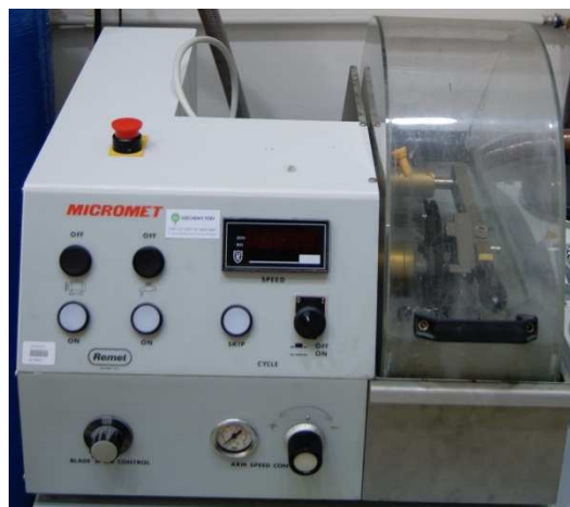
6. ábra REMET vágógép
