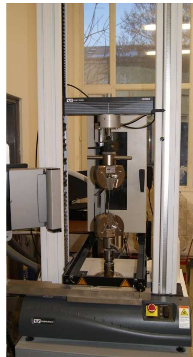
16. ábra Instron szakítógép
