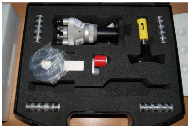
12. ábra Elcometer 106 adhéziómérő készülék
