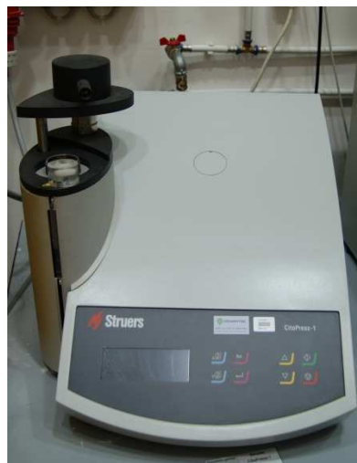
5. ábra Struers CitoPress-1 meleg beágyazó gép
