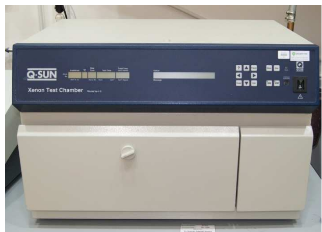
8. ábra Q-SUN Xenon lámpás öregbítő kamra
