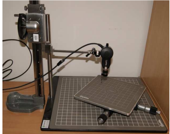
14. ábra Optilia videomikroszkóp
