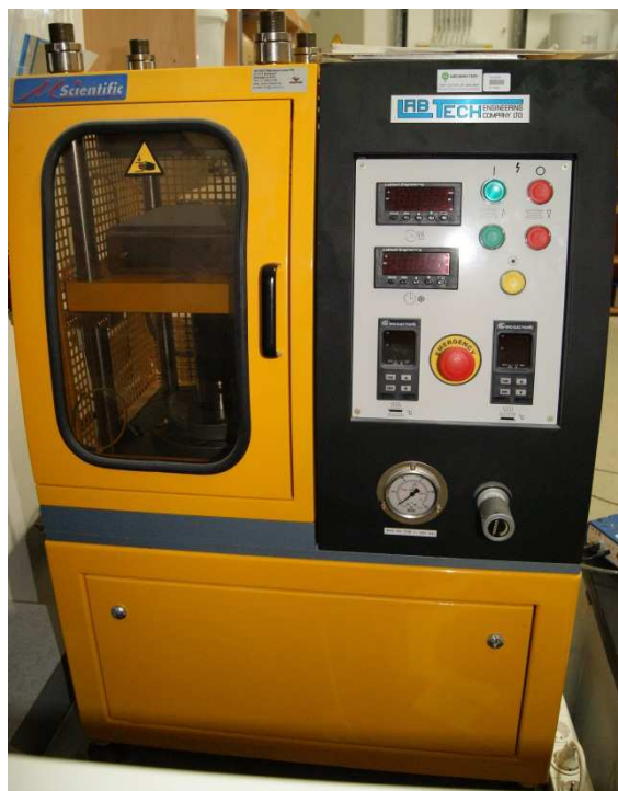
3. ábra Hidraulikus prés gép
