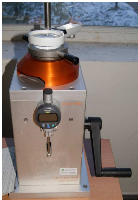
11. ábra Elcometer 1620 csészehúzó/mélyhúzó készülék
